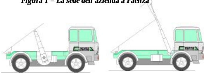
Figura 2 – Applicazione dei cilindri sottocassa e frontali
